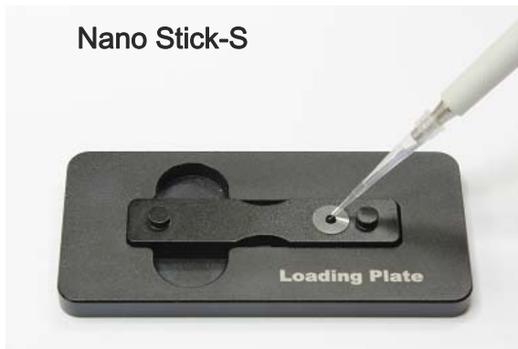
1. Pipette the Blank
